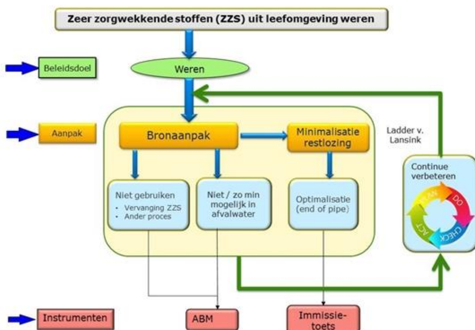
Figuur 8. Schematische weergave van doel en werkwijze voor het weren van zeer zorgwekkende stoffen uit de leefomgeving.
