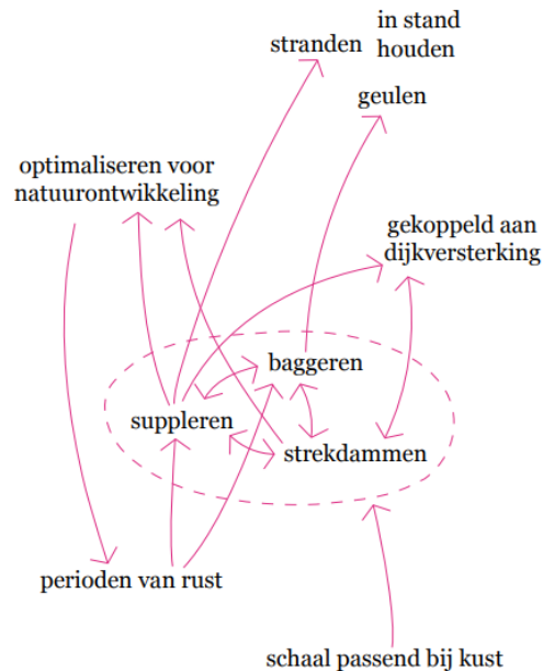
Diagram met de variabelen die betrokken moeten worden bij het ontwerp van het 'casco' van de vooroever van de Friese IJsselmeerkust
